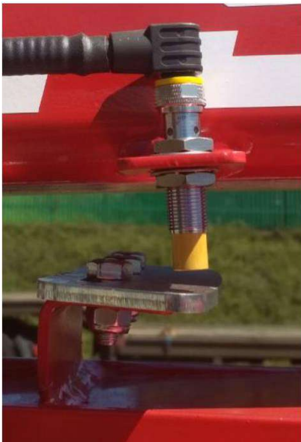
рисунок 22. Установка индукционного датчика оборотов
