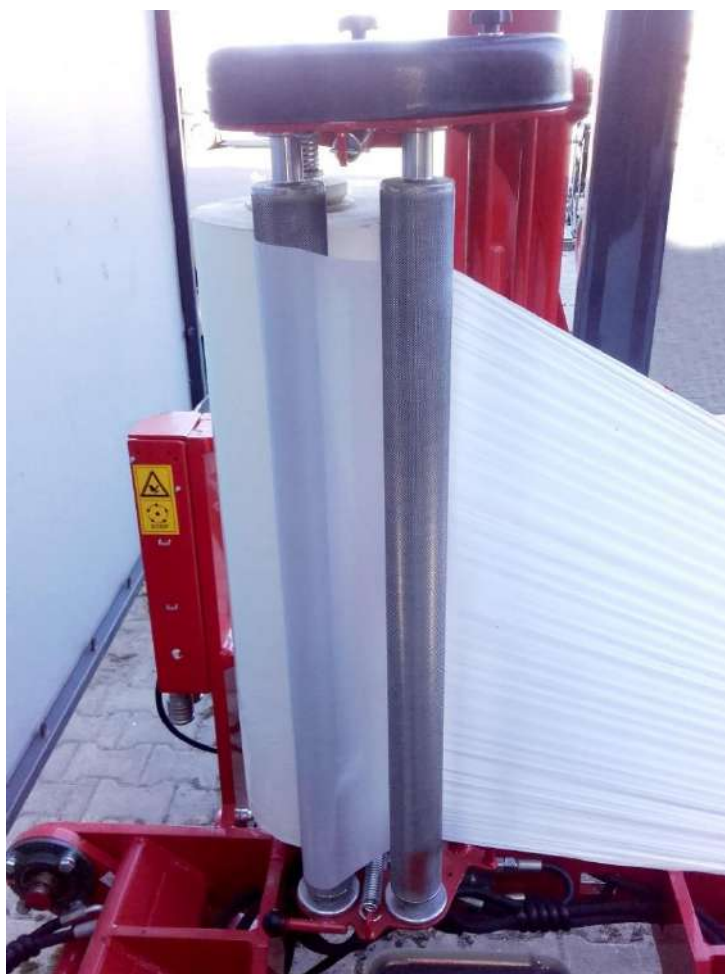
рисунок 33. Правильная установка пленки в подавателе
