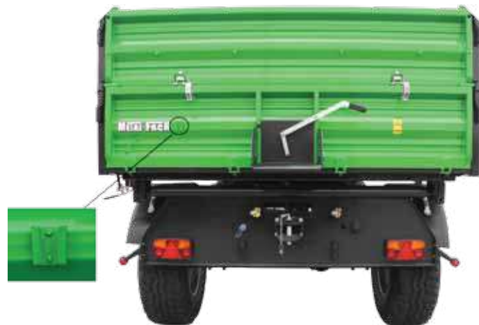
Рис. 4. Размещение опознавательного знака тихоходных транспортных средств
