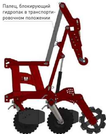
Рис. 11. Способ блокировки культиватора в транспортном положении.
