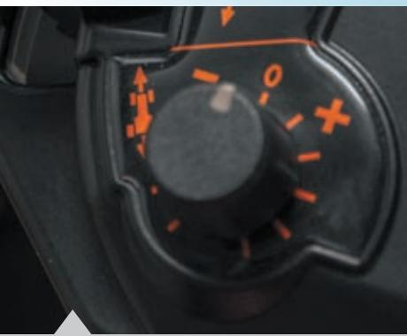
**Ручка системы регулировки плавности хода**
