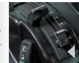
Органы управления системой ELC в расширенной версии.
