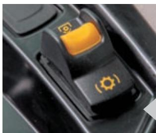
Включение BOM остается электрогидравлическим и осуществляется при помощи трехпозиционного переключателя («Включено», «Выключено» и «Заблокировано/торможение»).
